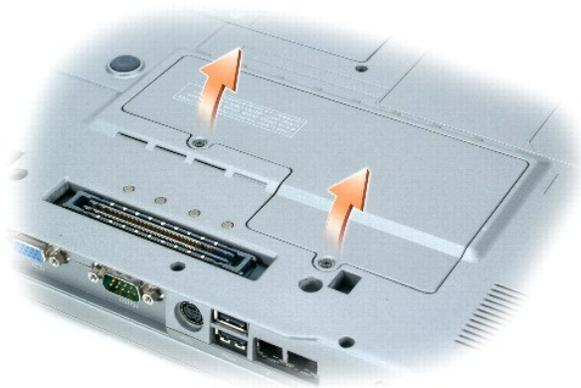
3. Wenn noch kein Modem installiert ist, fahren Sie mit [Schritt 4](#) fort. Wenn Sie ein Modem auswechseln, zunächst das alte Modem entfernen:
