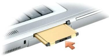
Der Computer erkennt die meisten PC Cards und lädt automatisch die entsprechenden Gerätetreiber. Verwenden Sie die mit Ihrer PC Card gelieferte Diskette oder CD, wenn das Konfigurationsprogramm Sie auffordert, die Treiber des Herstellers zu laden.
