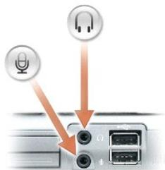
Schließen Sie an den mit dem Symbol
