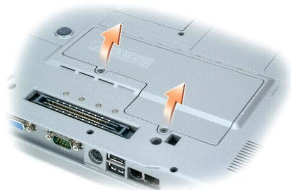
3. Falls noch keine Mini-PCI-Karte installiert ist, fahren Sie mit [Schritt 4](#) fort. Wenn Sie eine Mini-PCI-Karte auswechseln, entfernen Sie zunächst die alte Karte:
