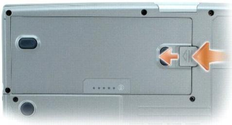
9. Entfernen Sie alle installierten Module, einschließlich des zweiten Akkus, sofern dieser verwendet wird.
